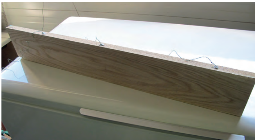
Proefstuk eiken met ingebrachte sensoren.
